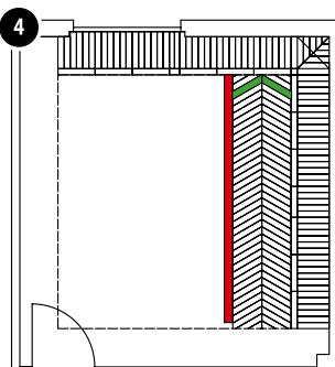
**Posare il primo Chevron del tappeto centrale come evidenziato in figura. Utilizzare il bindello posato in precedenza e una staggia adeguatamente posizionata come guida. Proseguire la posa fino a terminare l'intera sezione.**
