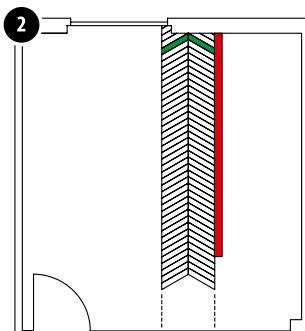
**Posare il primo Chevron come illustrato. Utilizzare una staggia adeguatamente posizionata come guida. Proseguire la posa fino a terminare la sezione lasciando uno spazio libero per la via d'uscita.**
