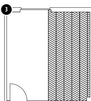
**Completare la posa della prima metà della stanza, posando una sezione alla volta, sempre con l'aiuto di una staggia adeguatamente posizionata.**
